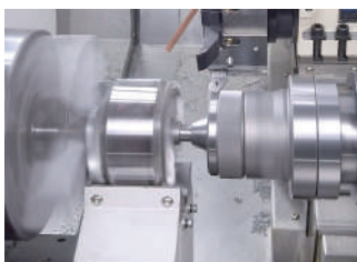
Subhusillo tipo electromandrino, que permite acabar la cara amarrada en el husillo principal
