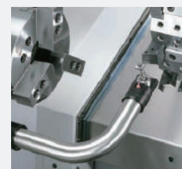
Brazo medidor de herramienta Tool presetter
