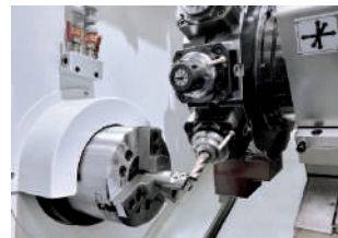
Eje Y para realizar operaciones completas de fresado
