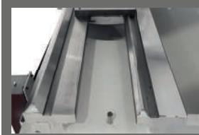
GUÍAS TEMPLADAS HARDENED GUIDEWAYS
