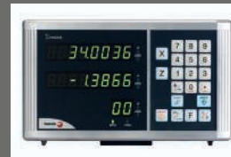
VISUALIZADOR FAGOR, 2 EJES FAGOR DRO X - Z
