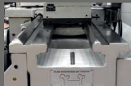
GUÍAS TEMPLADAS HARDENED GUIDEWAYS
